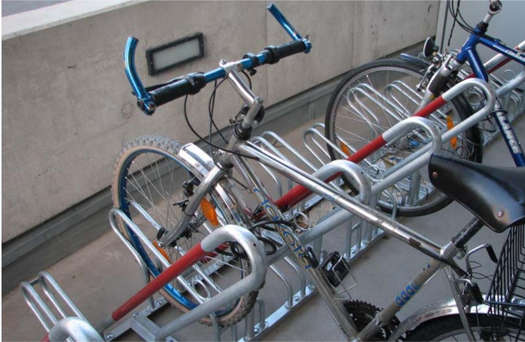
Der Bügel erlaubt viele verschiedene Befestigungsmöglichkeiten, je nach Rahmenhöhe und -typ und mit verschiedenen Schlössern. Somit kann der Radständer als vollwertig eingestuft werden. Das Rad wird durch den Bügel auch gestützt und ein Umfallen effektiv verhindert.
